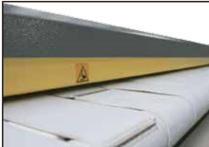
**VENTANAS DE PROTECCIÓN:** en la calandra **con plegadora** las ventanas de protección por debajo de la mesa de introducción permiten controlar sin ningún riesgo el correcto funcionamiento de la plegadora o verificar ropa encajada.
